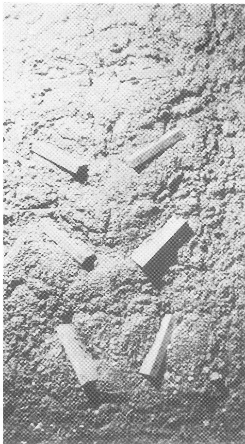
Photos 7, 8, 9. Cryoexpulsion de plaques posées de chant. Situations au 4 ème , 7 ème et 12 ème cycles. La position relevante avec bourrelets à l'aval des plaques sera conservée jusqu'à la fin de l'essai
